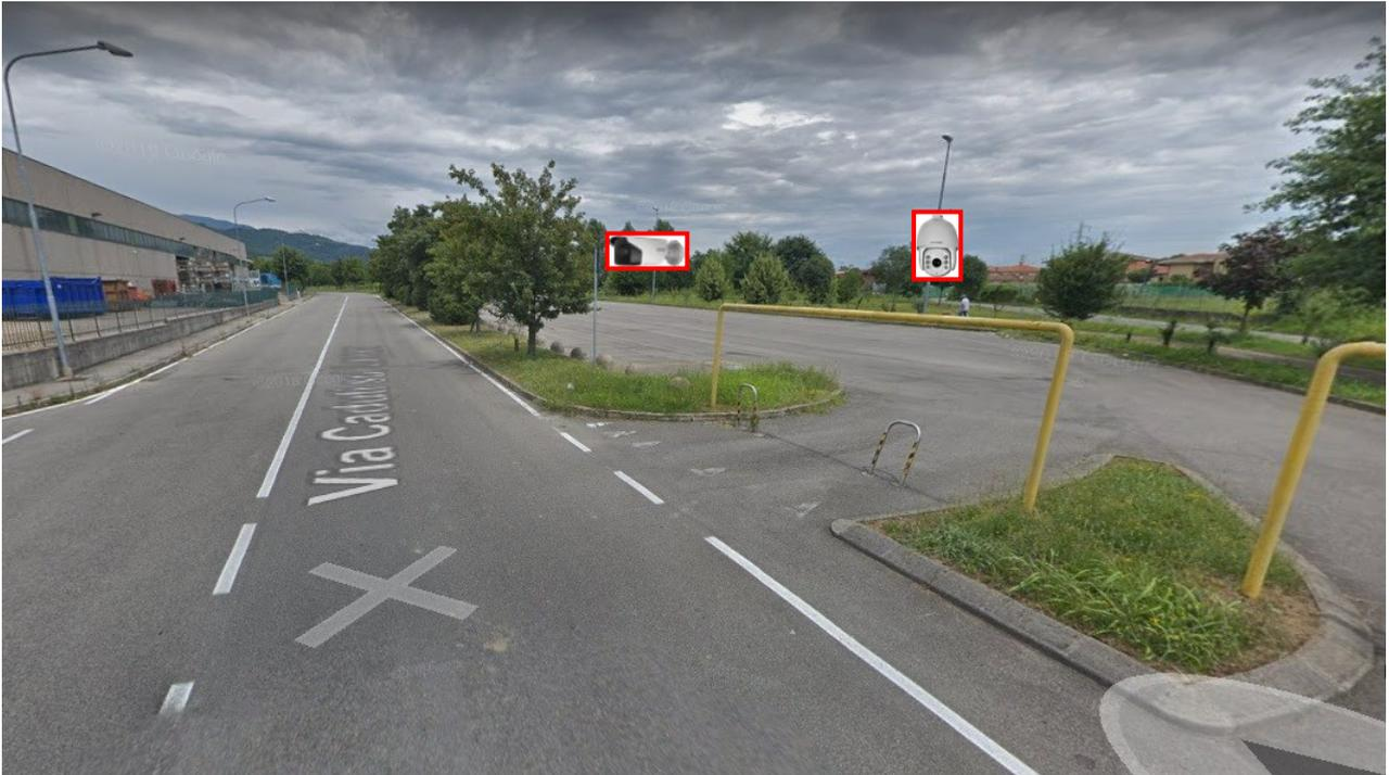
Sarà realizzato un nuovo sito ambientale su palificazione esistente di proprietà comunale, il sito sarà composto da 1 telecamera PTZ (Speed dome con funzione autotracking); sarà fornito un box elettrico contenente uno switch PoE 8 porte con 1 Mgbic per il collegamento in fibra ottica con Varco 1A Via Caduti del Lavoro
