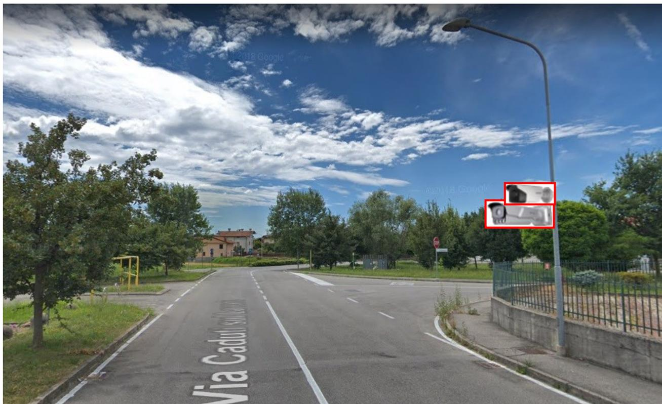
Sarà realizzato un nuovo varco di lettura targhe su palificazione esistente di proprietà comunale, il sito sarà composto da uno sbraccio di circa 2 metri per installare 1 telecamere di lettura targhe e 1 telecamera di Contesto; sarà fornito un box elettrico contenente uno switch PoE 8 porte con 2 Mgbic per il collegamento in fibra ottica con "Rilancio Mercatone" e Sito 1B Parcheggio.
